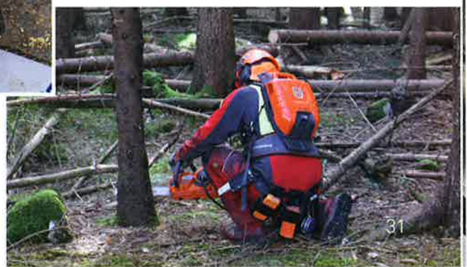
Bei Verwendung des Rückenakkus darf man nicht vergessen regelmäßig Öl nachzufüllen.
