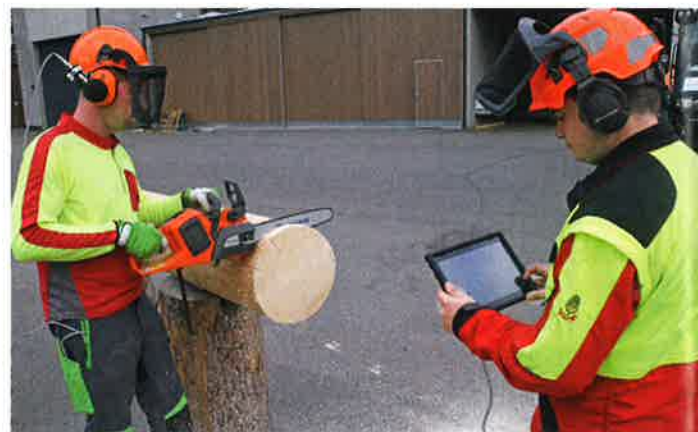
Um die Schnittleistung zu beurteilen, wurden beim Trennschnitt möglichst rasch mehrere Stammscheiben hintereinander abgeschnitten.
