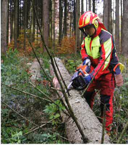
Die Motorsägen wurden bei zwei typischen Arbeitsschritten getestet: zum einen beim Trennschnitt und zum anderen beim Entasten. Um vergleichbare Bedingungen herzustellen, ging der Vergleich auch an Wettkampfbäumen vorstatten.
