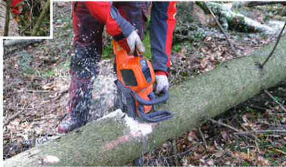
Die Motorsägen wurden bei zwei typischen Arbeitsschritten getestet: zum einen beim Trennschnitt und zum anderen beim Entasten. Um vergleichbare Bedingungen herzustellen, ging der Vergleich auch an Wettkampfbäumen vorstatten.
