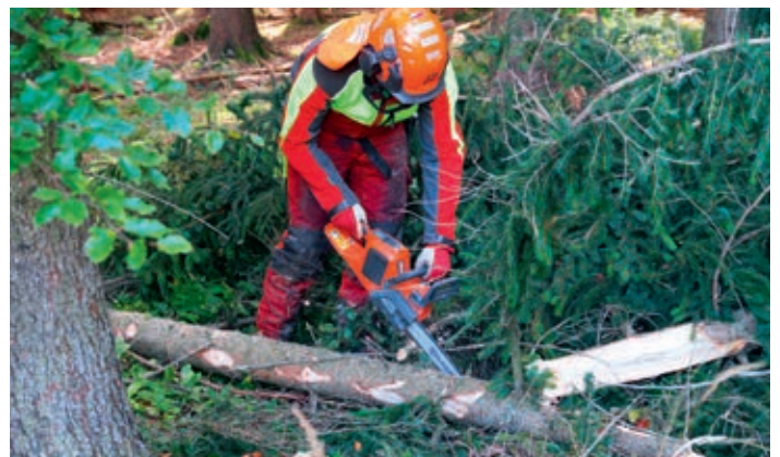
Die Akkumotorsägen werden zunehmend leistungsfähiger und eignen sich immer mehr für den Einsatz im Wald. So etwa für das Entasten.
