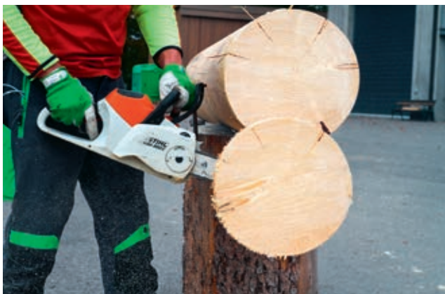
Zur Beurteilung der Schnittleistung wurden an einem Stamm möglichst rasch mehrere Scheiben hintereinander abgesägt.
