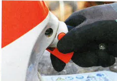
Bei der Stihl MSA 200C muss der Motorsägenführer den Sperrknopf drücken, damit die Säge läuft.
