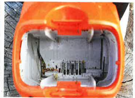
Verschmutzungen des Akkuschachtes können bei der Säge von Stihl dazu führen, dass der Kontakt zwischen Akku und Säge unterbrochen wird.
