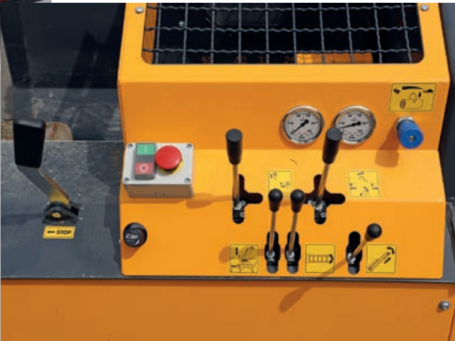
Die beiden Hauptsteuerhebel bedienen links den Spaltvorgang und rechts die Zuförderung und das Abschneiden. Die Hilfssteuerhebel steuern Zubringung und Abtransport.
