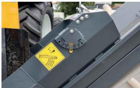
Die Neigung des Förderbandes sollte je nach Scheitlänge zwischen 30° und 45° liegen und ist seitlich gut ablesbar.
