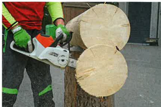
Zur Beurteilung der Schnittleistung sägten die Testpersonen in der Disziplin „Trennschnitte“ möglichst rasch mehrere Stammscheiben hintereinander ab.
