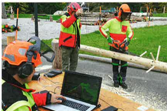
Die Akku- und Benzinsägen wurden von verschiedenen Testpersonen an Wettkampfbäumen getestet, um ähnliche Bedingungen herzustellen.
