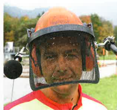
Die Lärmbelastung wurde direkt am Ohr der Testperson gemessen.
