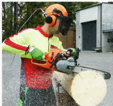
Die Lärmbelastung wurde direkt am Ohr der Testperson gemessen.
