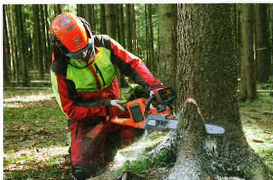
Die gute Schnittleistung der Akkumotorsägen wird vor allem durch die vergleichsweise geringe Kettenbreite erreicht.
