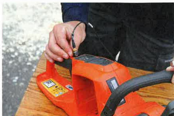
Um mehr über die Vibrationsbelastung zu erfahren, waren an beiden Handgriffen der Testsägen hochempfindliche 3D-Beschleunigungssensoren positioniert.
